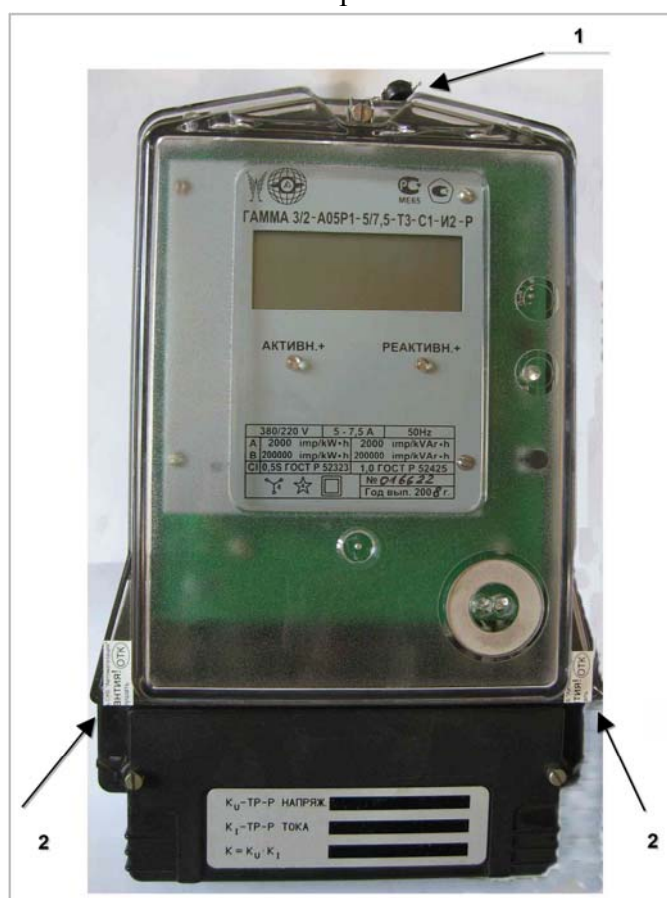
1 – пломба поверителя; 2 – места обклейки гарантийными наклейками завода-изготовителя. Рисунок 1.
